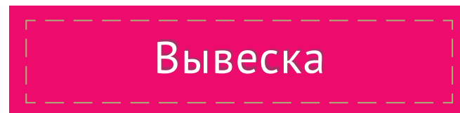
Рис. 2-24. Условное обозначение вывески на световом коробе. Пунктиром ограничена максимально допустимая зона для размещения элементов вывески
