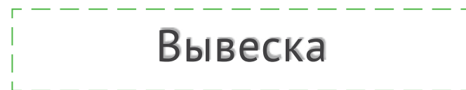
Рис. 2-5. Условное обозначение вывески из отдельно стоящих букв и знаков без подложки, принятое в АХК и используемое в этом альбоме. Пунктиром ограничена максимально допустимая зона для размещения элементов вывески
